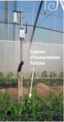
Photo 2 : sonde climatique connectée permettant de suivre précisément la température, l'hygrométrie relative et l'humectation foliaire
