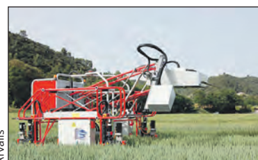
Phénomobile permettant le phénotypage de la biomasse aérienne des cultures.
