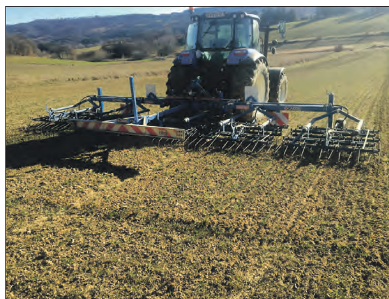
Laurence Curnier a investi grâce au Plan de relance de l'État il y a trois ans dans une herse étrille pour désherber son blé tendre.
